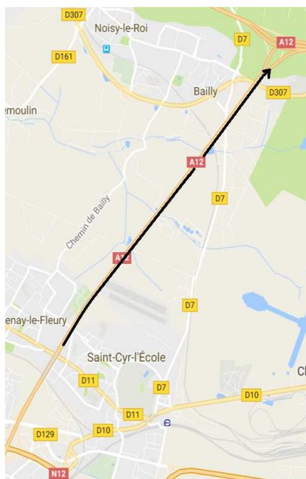
Cette voie dédiée aux bus sur l'autoroute A12 est **une voie supplémentaire qui sera implantée à droite des voies de circulation existantes, sur l'espace Bande d'Arrêt d'Urgence (BAU)**. Elle s'étendra sur un linéaire de 3 875 mètres, jusqu'au divergent permettant de rejoindre l'autoroute A13.
