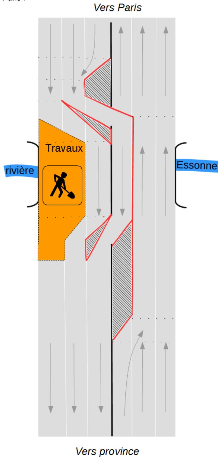
Les voies de circulation sont de largeur réduite pendant toute la durée des travaux. Aussi, la **vitesse maximale autorisée est fixée à 70 km/h au droit des travaux dans les deux sens de circulation**. Cette disposition fait l'objet de contrôles aléatoires ou continus automatiques pour en assurer le respect.
