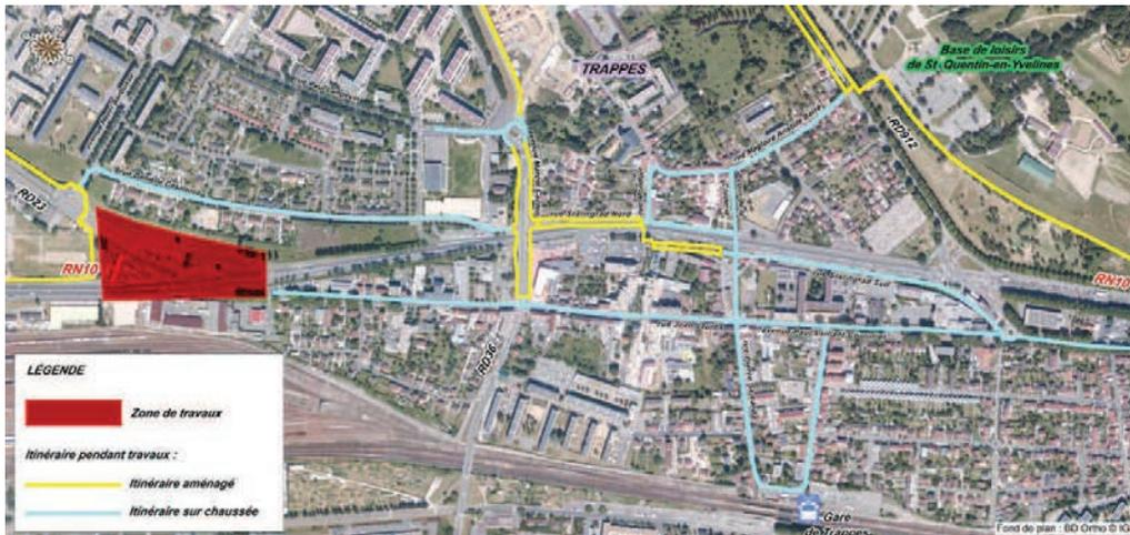
Figure 99 : Organisation des circulations des modes actifs en phase travaux lors de l'aménagement du carrefour RN 10/RD 23 (source : Dossier d'études préalables, DIRIF, mars 2015)
