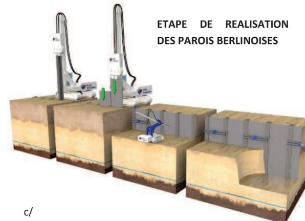
Figure 104 : Méthodes de construction de tranchée couverte (a/ Exemple de réalisation « en taube » avec construction de deux tranchées simultanément - source : <http://www.enroute.ile-de-france.developpement-durable.gouv.fr/> ; b/ Etapes de réalisation de parois moulées - <http://www.societedugrandparis.fr/> ; c/ Etapes
