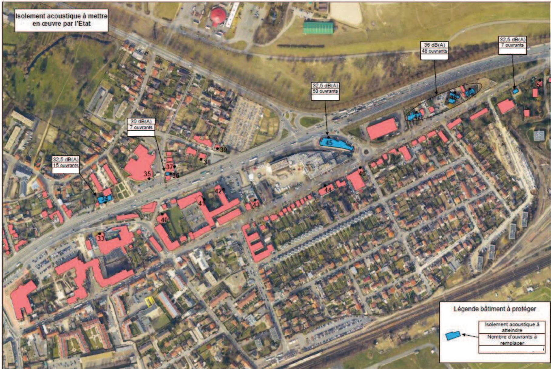
Figure 16 : Identification des bâtiments nécessitant la mise en œuvre d'un isolement acoustique 2/2 (source, Etude acoustique du projet de requalification de la RN 10, Iris Conseil, juin 2015)
