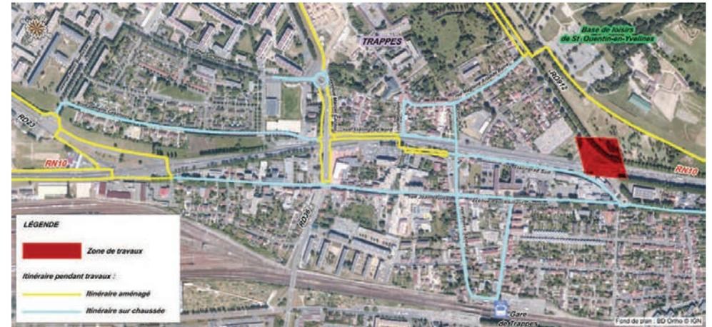
Figure 100 : Organisation des circulations des modes actifs en phase travaux lors de l'aménagement du carrefour RN 10/RD 912 (source : Dossier d'études préalables, DIRIF, mars 2015)
