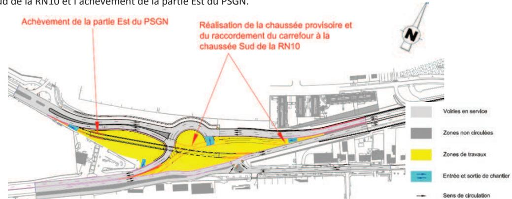
Figure 89 : Phase 3 de la réalisation des travaux au niveau du carrefour RN 10/RD 23 (source : Dossier d'études préalables, DIRIF, mars 2015)
