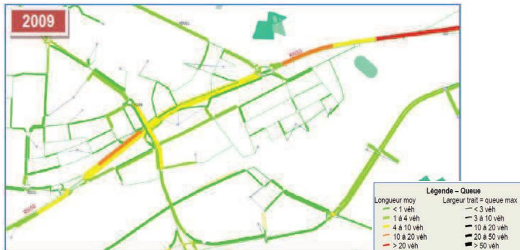
Figure 179 : Importance des remontées de files à l'HPS sur le secteur de Trappes-en-Yvelines (source : Etude de trafic, SORMEA, Janvier 2015)
