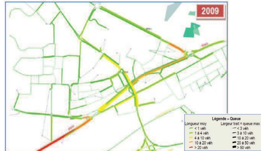
Figure 178 : Importance des remontées de files à l'HPM sur le secteur de Trappes-en-Yvelines (source : Etude de trafic, SORMEA, Janvier 2015)
