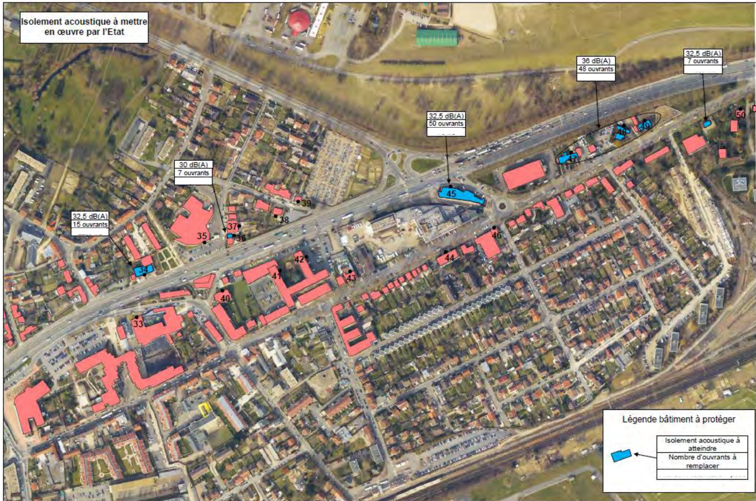
Figure 35 : Identification des bâtiments nécessitant la mise en œuvre d'un isolement acoustique 2/2 (source, Etude acoustique du projet de requalification de la RN 10, Iris Conseil, juin 2015)
