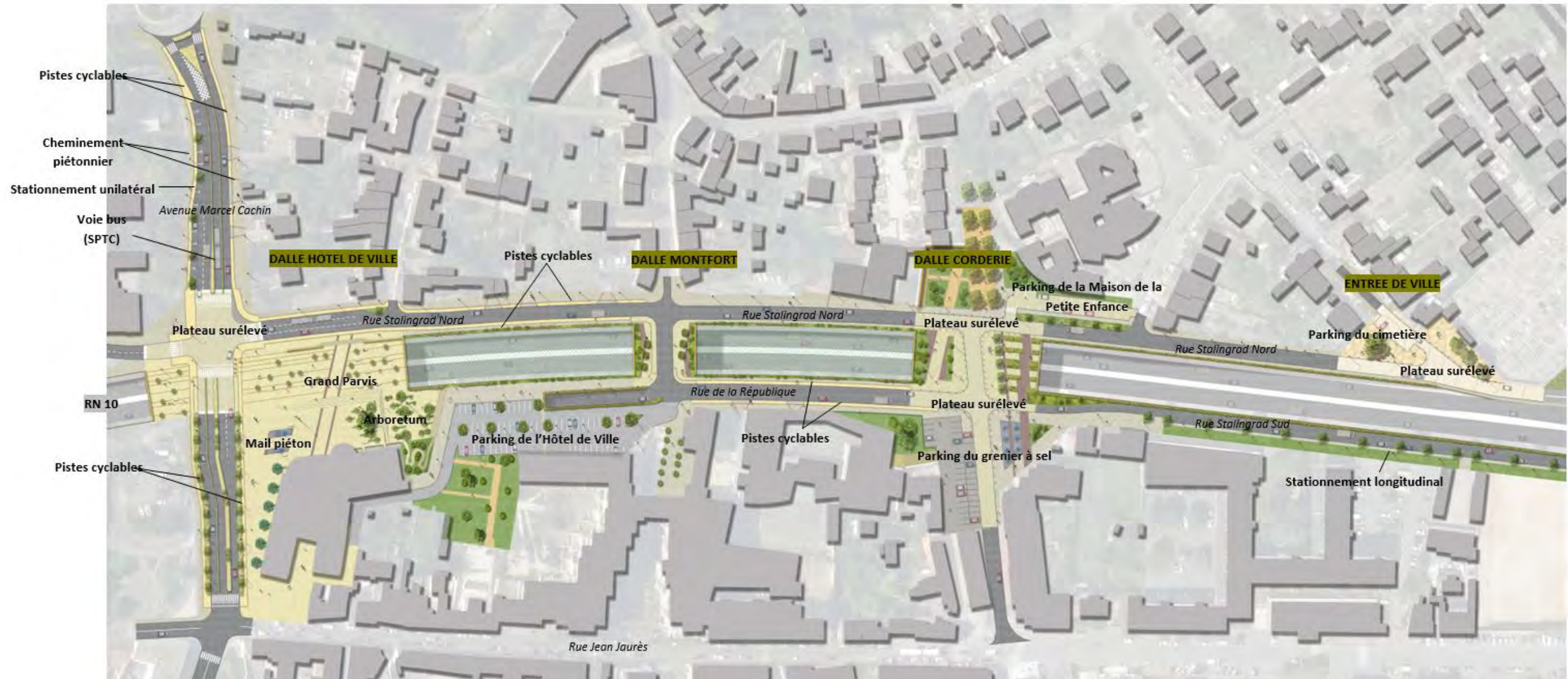
Figure 4 : Vue en plan générale du projet d'aménagement de surface du plateau urbain de la RN 10 (source : AVP AEI/Ingérop, 2012)
