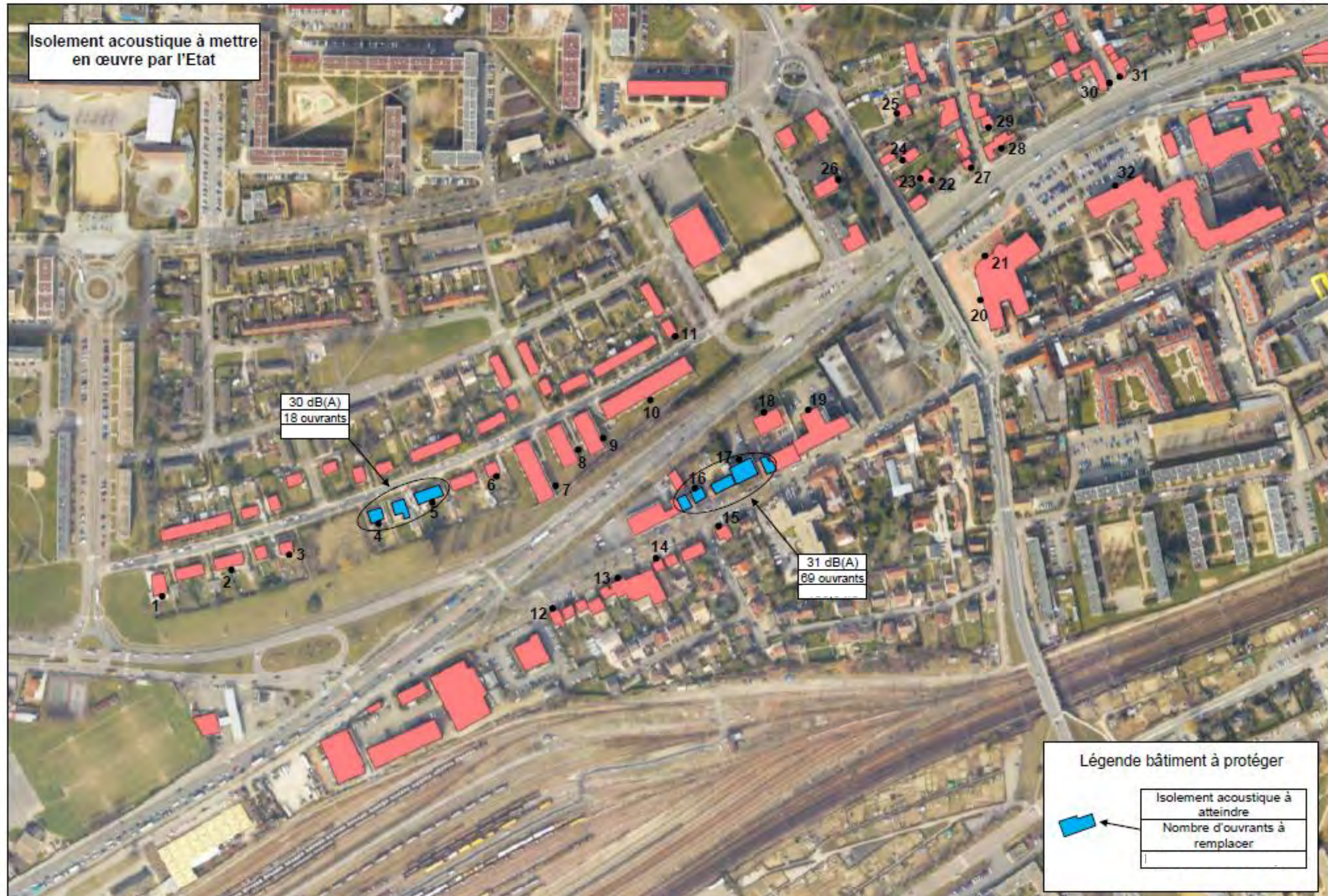
Figure 34 : Identification des bâtiments nécessitant la mise en œuvre d'un isolement acoustique 1/2 (source, Etude acoustique du projet de requalification de la RN 10, Iris Conseil, juin 2015)
