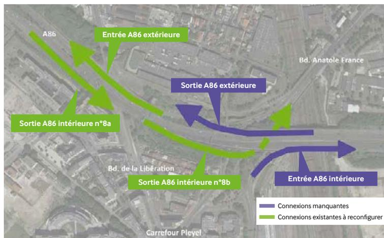
Figure 6 : État des lieux des connexions au niveau de l'échangeur de Pleyel
