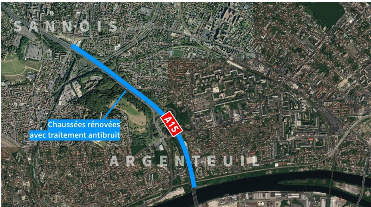
Dans le cadre de travaux de rénovation des chaussées de l'autoroute A15 au niveau d'Argenteuil et Sannois, ce revêtement innovant à caractéristiques phoniques spécifiques est posé sur une section à 4 voies de circulation d'environ 2000 mètres dans le sens Paris – province bordée par les bâtiments d'habitation.
