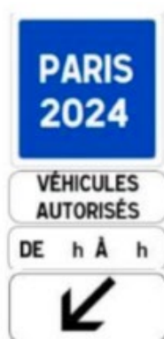
Signalisation en début de voie réservée Panneaux fixes
