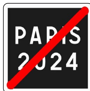
Signalisation en fin de voie réservée Panneaux lumineux
